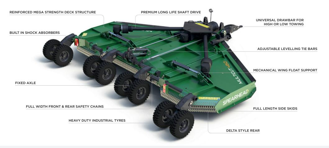
AGRICULTURE SLIP CLUTCH PROTECTION 250HP SPLITTER BOX PASTURE LIGHT SCRUB 111HP ROTOR BOX HEAVY SCRUB INTEGRATED SEAL PROTECTOR AIRFIELD A ANTI-SCALP DISC HIGHWAYS
